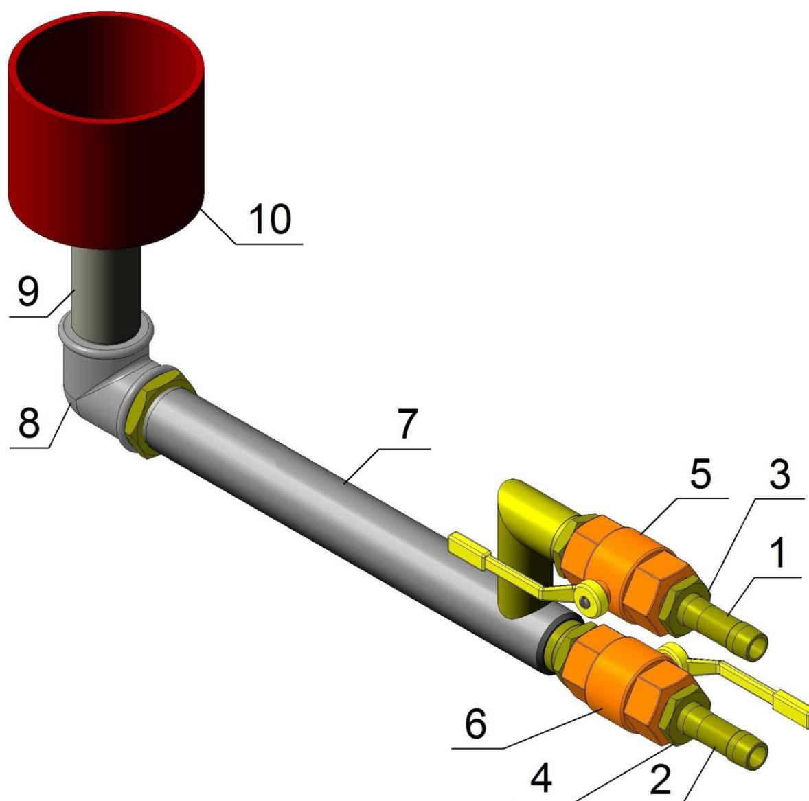
1 – Ниппель горючего газа; 2 – Ниппель окислителя; 3 – Гайка горючего газа; 4 – Гайка окислителя; 5 – Кран горючего газа; 6 – Кран окислителя; 7 – Трубка; 8 – Колено (Ниппель); 9 – Трубка; 10 – Мундштук.
